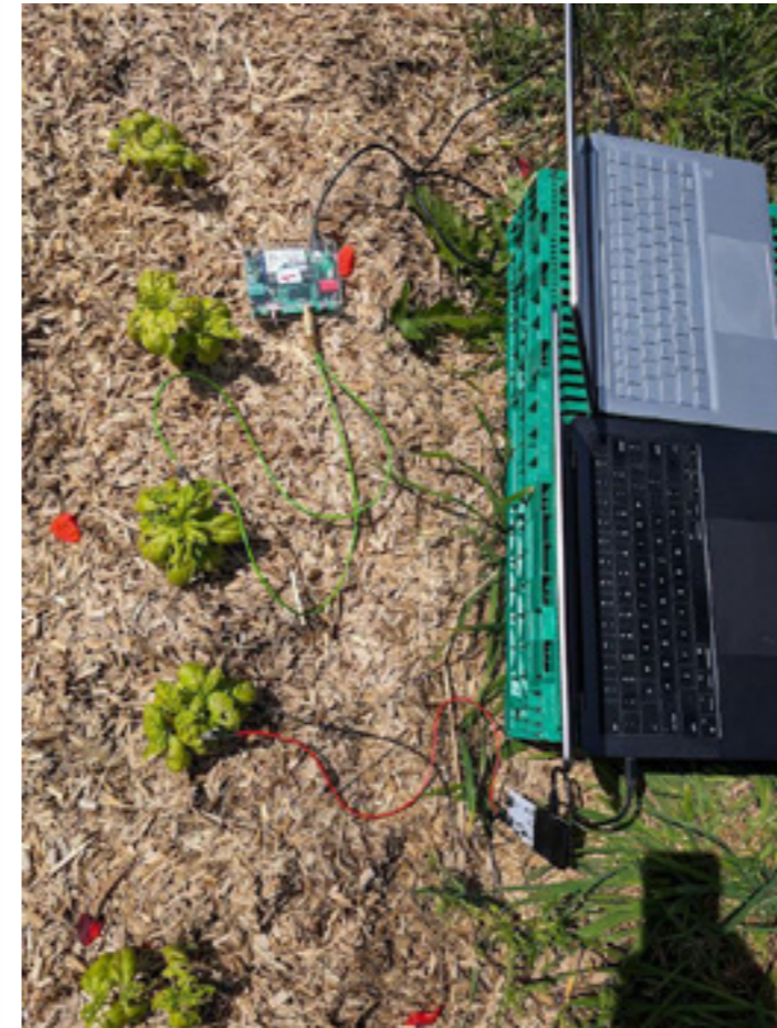
Abb. 39: Geräte zum Messen des Elektropotentials: Spikerbox (oben) und Oxocard (unten).
